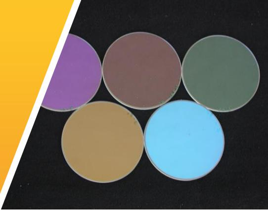
Bei der Entspiegelung von Polymeren müssen die spezifischen Eigenschaften der unterschiedlichen Kunststoffmaterialien wie Wärmeausdehnung, thermische Belastbarkeit, Quellverhalten und Schichthaftung berücksichtigt werden.
