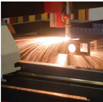
Резка труб прямоугольного сечения Tube cutting
