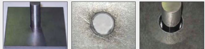
Отверстие 12 мм, вырезанное с помощью системы плазменной резки HPRXD® без использования технологии True Hole. 12 mm hole without True Hole technology cut with HPRXD® Plasma.
