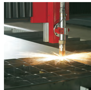
Резка с использованием технологии True hole True hole cutting
