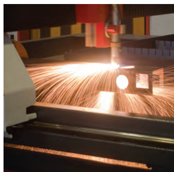
Резка труб прямоугольного сечения Tube cutting
