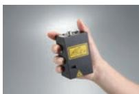
Laser autocollimator (LAC)
